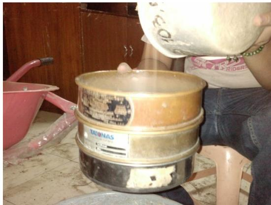
**Gambar 3.8.** Penyaringan Tanah
