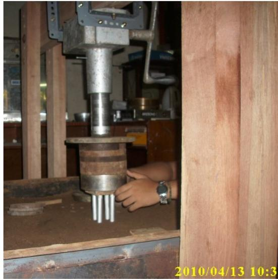
**Gambar 3.11.** Pemasangan pondasi tiang
