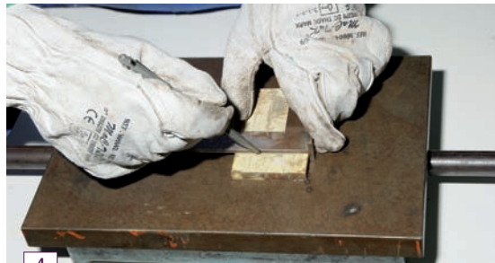
4 Trazado de paralelas.
