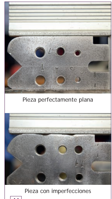
44 Comprobación del estado de las superficies limadas.
