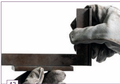
42 Verificación de planitud con escuadra.
