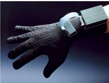
Instrumentado con catorce (14) sensores que registran la flexión de los dedos (dos – 2 – sensores en cada uno) así como la separación entre los mismos. Cómodo por su fabricación en lycra extensible de color negro. Calibración automática, procesador incorporado, conexión independiente de la plataforma a través de interfase de puerto serial (RS 232) en “caliente” (estación de trabajo en operación)
