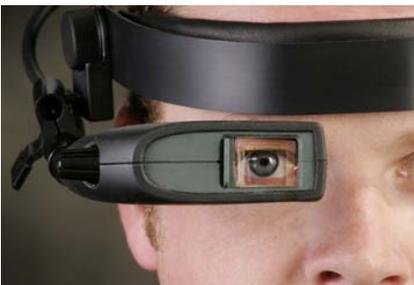
Visión a través o superpuesta. Fuente de imagen tipo OLED Full Color, resolución (800 x 3) x 600, luminiscencia (máx.) 70 cd / m<sup>2</sup> (frontal) SVGA 60Hz, modo VESA, óptica FOV 28" @ 800 x 600, soporte con banda rígida para cabeza (tipo sombrero) Información adicional en: <http://www.liteye.com>
