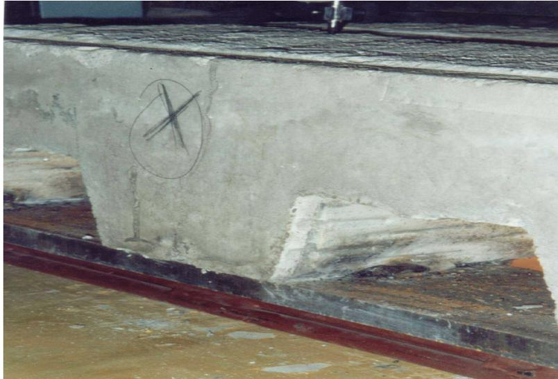
Figura C.3.a – Deslizamento relativo de extremidade
