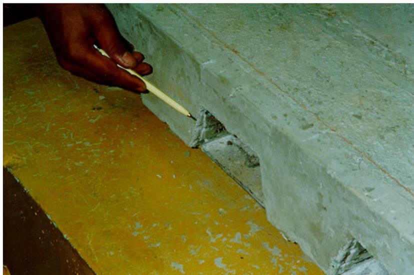
Figura C.3 – Deslizamento relativo de extremidade
