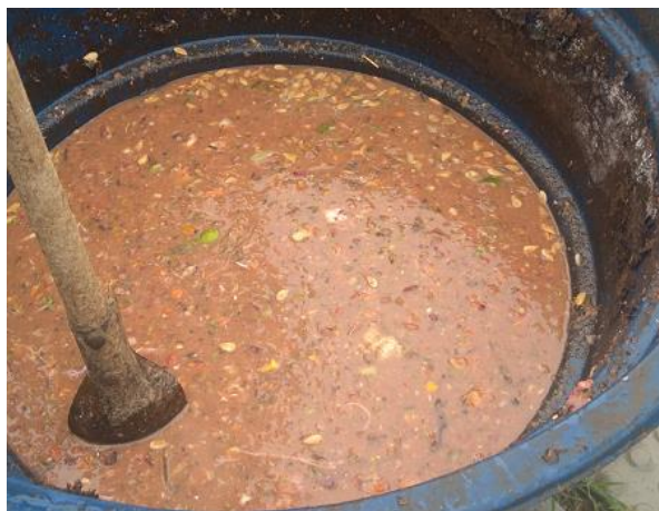
Figura 19-Mistura de resíduo de alimento e água para alimentação do biodigestor piloto.
