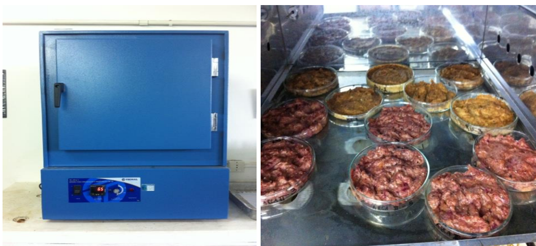
Figura 9-Resíduos de alimentos triturados acondicionados em estufa de secagem a 65°C.
