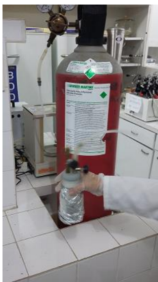
Figura 13-Reator anaeróbio acoplado ao cilindro contendo \text{N}_2
