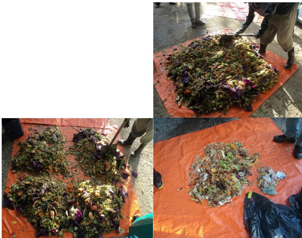
Figura 8-Técnica de quartejamento utilizada na amostragem dos resíduos de alimentos.
