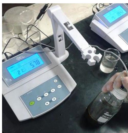
Figura 11-Medição direta do pH em amostra líquida.
