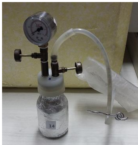
Figura 17-Preparação para coleta de biogás nos reatores
