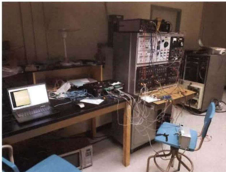
Figure C.2 : Branchement réel du système de filtrage actif SAPF
