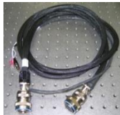
5) Laser Signal Cable
