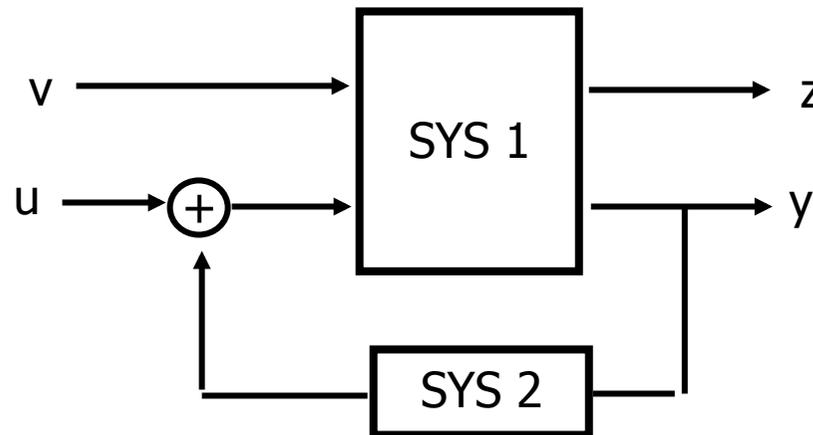
I vettori **FEEDIN** e **FEEDOUT** contengono rispettivamente gli indici degli ingressi e delle uscite del sistema SYS1 coinvolti nella retroazione. La variabile **SIGN** indica se si tratta di retroazione positiva (**SIGN** pari a +1) oppure negativa (**SIGN** pari a -1 oppure non assegnato).
