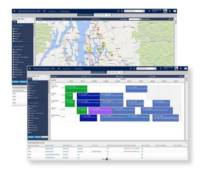
El programador con funcionalidad drag and drop permite a los operadores asignar recursos y preparar los programas de varias órdenes de trabajo utilizando un mapa o una vista en lista. La visualización en tiempo real y los indicadores de estado permiten una reasignación rápida y eficiente para responder a los cambios o situaciones de emergencia.
