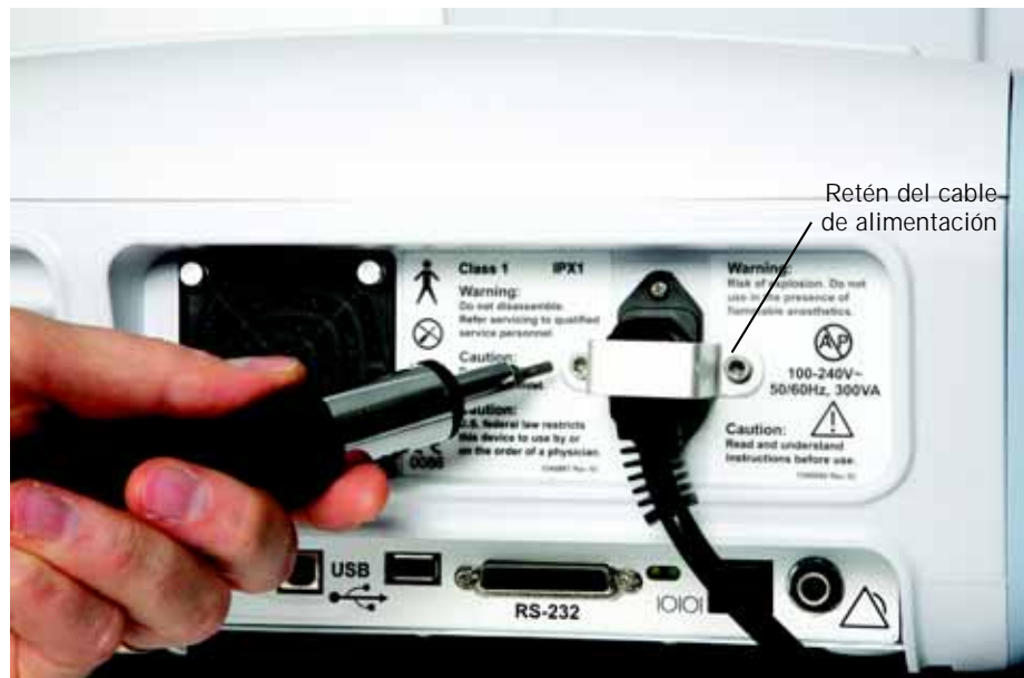
Figura A-4: instalación del retén del cable de alimentación
