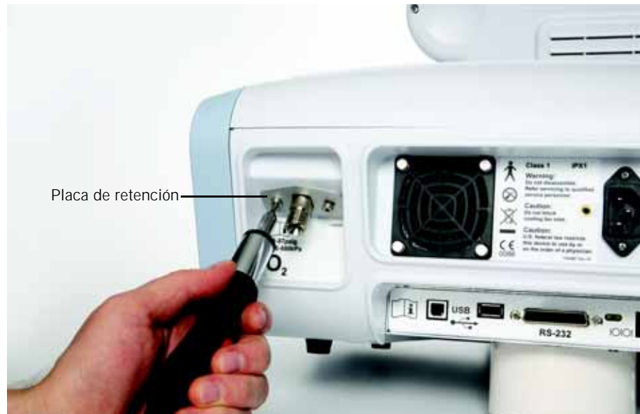
Figura A-3: instalación del conector de entrada de oxígeno
