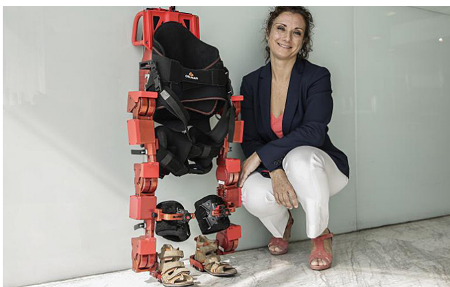
Figura 4. Exoesqueleto biónico desarrollado por Elena García Armada. Fuente Olmo Calvo.
