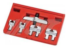
JTC-4647 CAMSHAFT DRIVE BELT PULLEY PULLER
