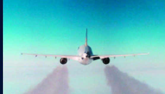
Nicht folgenlos: Großraumjets fliegen etwa 20 Prozent ihrer Flugzeit in so kalter und feuchter Luft, dass sie langlebige Kondensstreifen bilden
