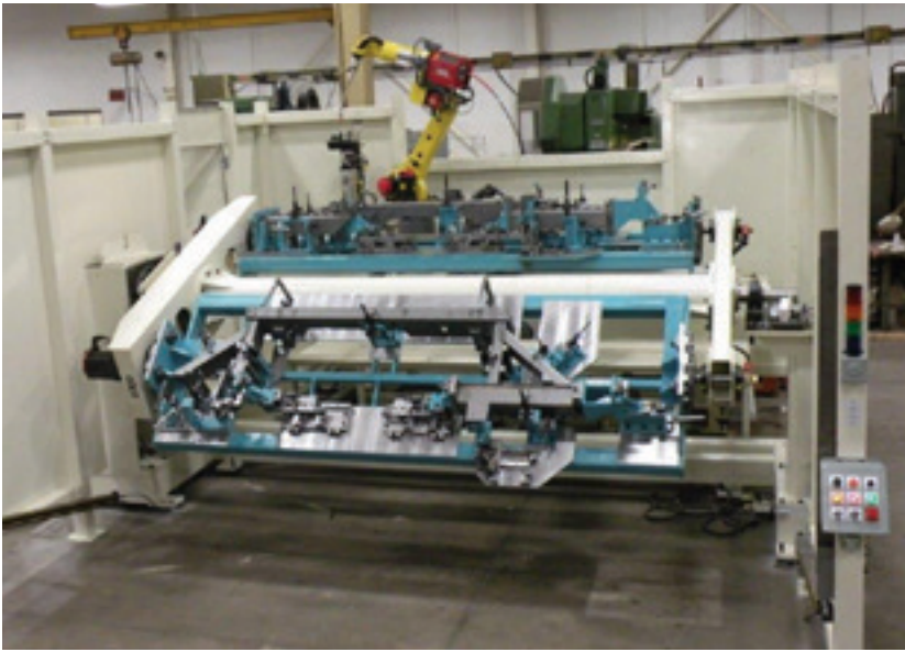
ROBOTIC MIG CELL
