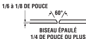
ASSEMBLAGE EN V SIMPLE
