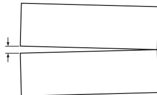
EXTREMOS QUE SE DESPRENDEN DURANTE LA SOLDADURA
