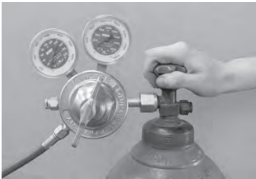
Figura 10: Abrir la válvula del cilindro
