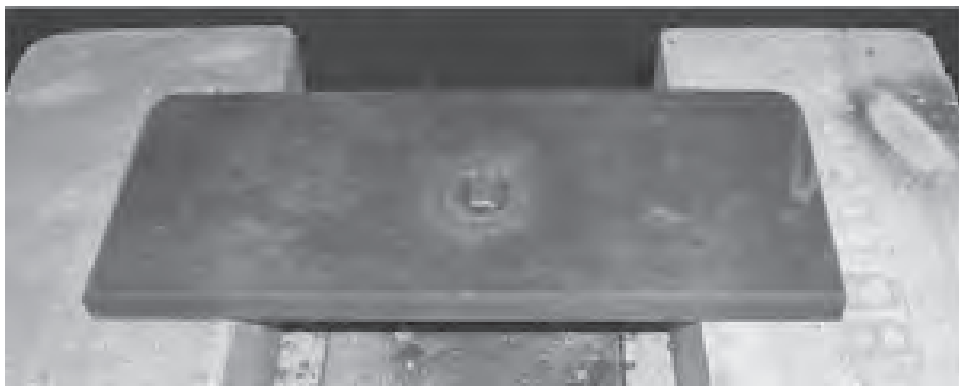
Figura 22: Corte mediante perforación
