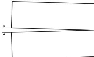
SÉPARATION DES EXTRÉMITÉS EN COURS DE SOUDAGE
