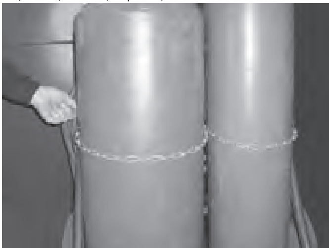
Figure 8: Blocage des bouteilles sur un chariot
