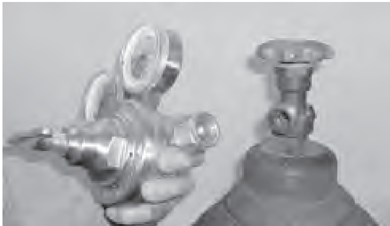
Figure 9: Inspection de la bouteille et du robinet
