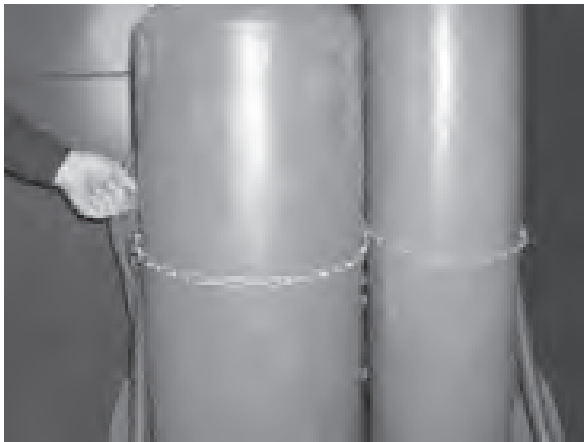
Figura 8: Cómo asegurar los cilindros en la carretilla
