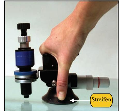
Streifen anheben, um Reparaturvorrichtung zu lösen
