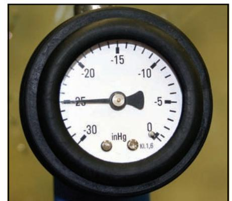
Pumpenmanometer mit 25 in/Hg Vakuum
