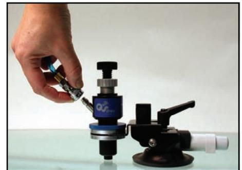
Befestigung der Schlaucheinheit an der Reparaturvorrichtung
