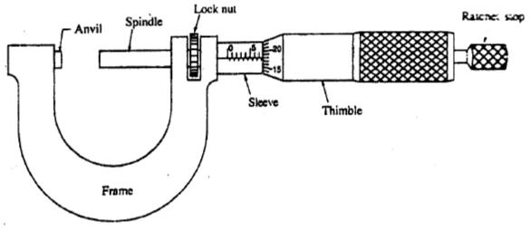
Fig. 2 Micrometer
