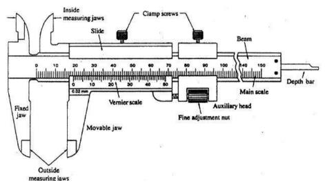
Fig. 3 Vernier caliper
