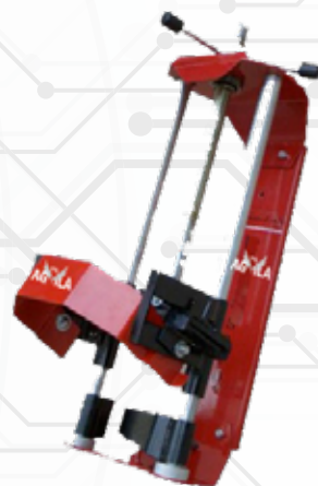
Modelo: B97 Marca: D'EL AGUILA Opresor de resortes de suspensión de pared.
