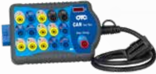
Modelo: 3415 Marca: OTC Caja de pruebas para comprobación de líneas CAN, no interrumpe comunicación para rea- lizar pruebas con motor encendido.
