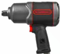
Modelo: 88070 Marca: GEARWRENCH Pistola de Impacto 3/4" Longitud: 221mm, peso 3.7Kg. Torque Max 1300ft/lbs. 1 Año de garantía.
