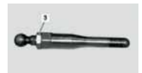
Kuva 1: Kytkintehostimen tanko voidaan säätää
