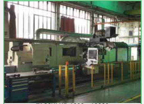
TACCHI HD 1000 x 12000 CNC Lathe
