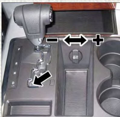
ERS Control Position
