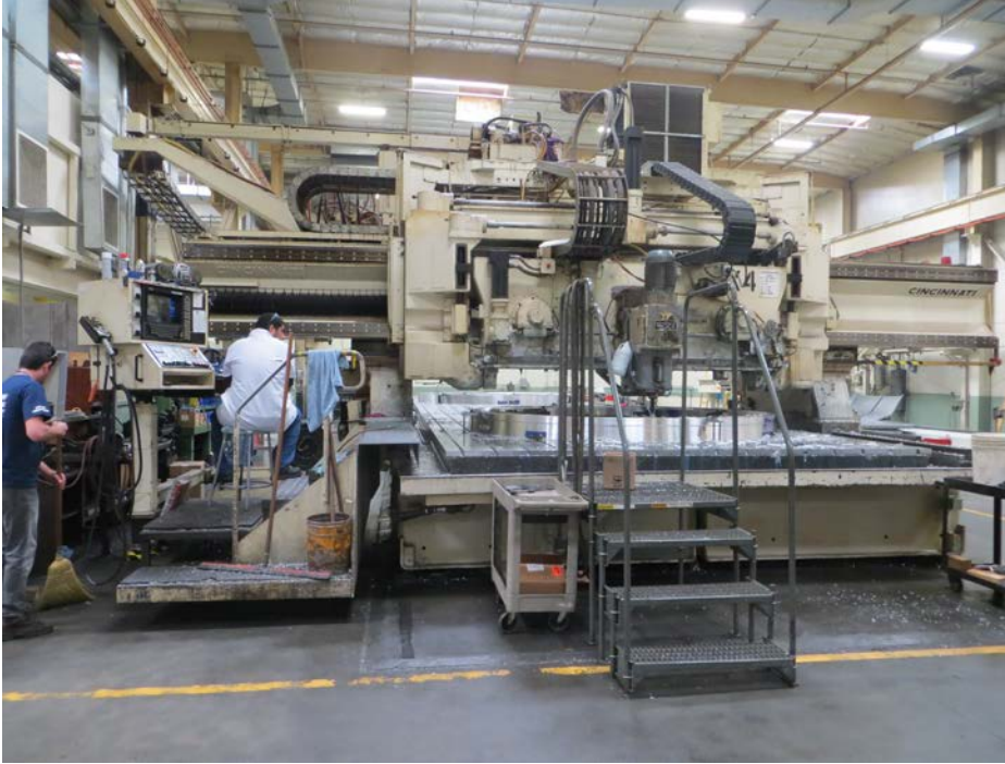
(X-4) Cincinnati 5 Axis Vertical Gantry X = 776", Y = 168", Z = 22" A - Axis \pm 20^\circ B - Axis \pm 20^\circ
