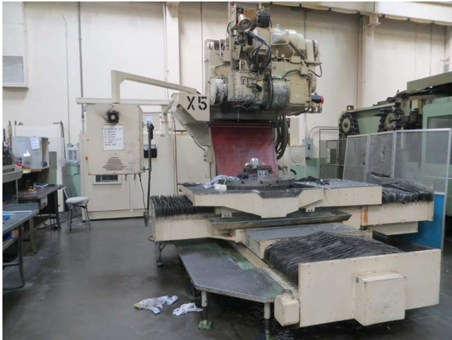
(X-5) Omnimil X5 X = 48", Y = 44", Z = 47.5" A = -26^\circ + 124.5^\circ , C = 360^\circ
