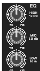
2.2. ábra: A monó bemeneti csatornák hangszínszabályozója
