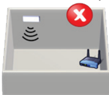
Antennen i vandret position og den vender ikke mod Wi-Fi Access Point eller router
