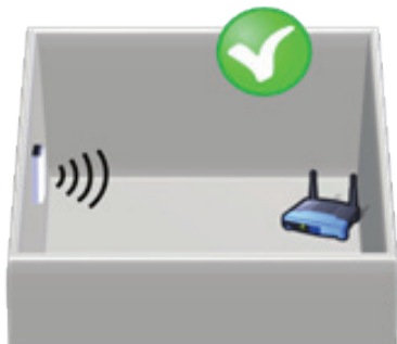
Antena en posición vertical y apuntando al Router o Punto de Acceso Wi-Fi
