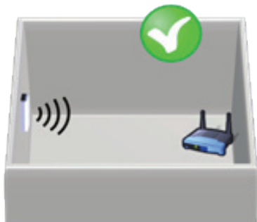
Antenne in vertikaler Position, zeigt direkt auf WLAN-Router oder Access Point.
