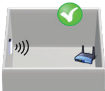
Antenna in posizione verticale e che punti all' Access Point o al Router Wi-Fi
