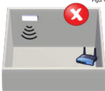
Antennen i horisontal posisjon og peker ikke mot Wi-Fi-tilgangspunktet eller ruteren
