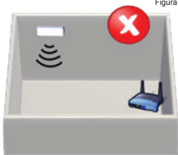
Antenna in posizione orizzontale e che non punti all' Access Point o al Router Wi-Fi
