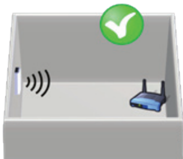
Antennen i vertikal posisjon og peker mot Wi-Fi-tilgangspunktet eller ruteren
