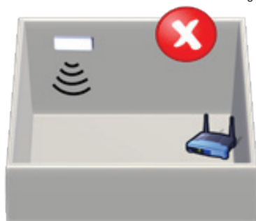
Antenne in horizontaler Position, zeigt nicht direkt auf WLAN-Router oder Access Point
