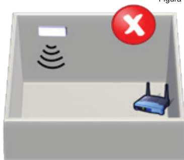
Antena en posición horizontal y sin apuntar al Router o Punto de Acceso Wi-Fi
