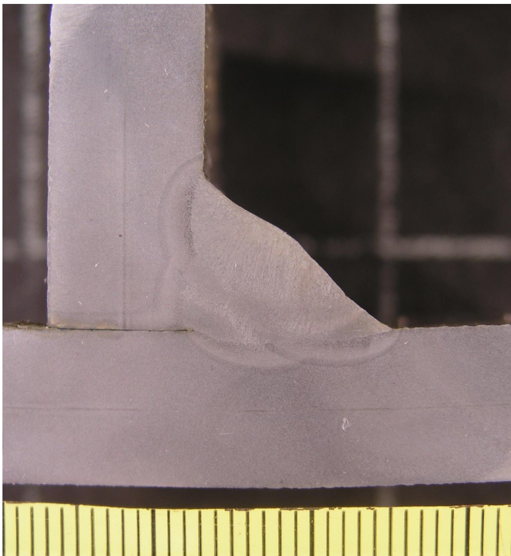
Slika 20. Makro uzorak 2 nakon poliranja
