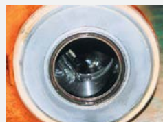
Термическое н пыление WC (к рбид вольфр м )
