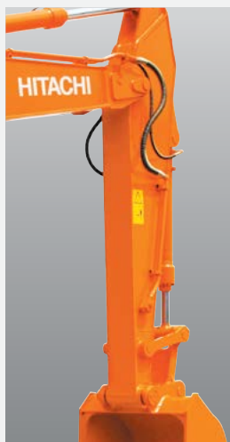
Основные трубопроводы рабочего оборудования
