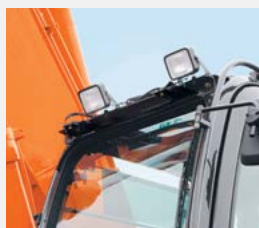
Дополнительные передние фонари освещения на крыше кабины
